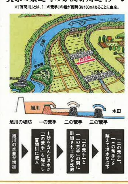
貞享三年（六八六）、堤や荒手（越流堤）を備えた放水路が築造され、一定量を超えた旭川の水が荒手を越えて百間川へ分流することで城下を洪水から守る仕組みを実現させました。
